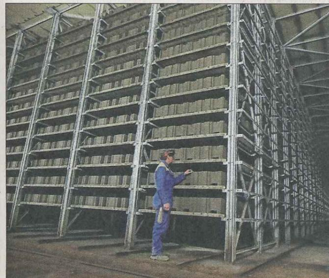
Deux à trois jours de séchage sont nécessaires dans un hangar, pour fixer le mélange et la forme des blocs.
