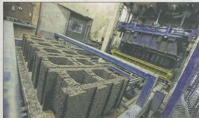
Le mélange bois-ciment est façonné selon la forme et l'épaisseur voulues. Le bloc pourra être scié et percé si besoin pour s'adapter à son usage.
