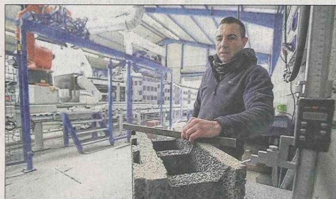
Les blocs vont passer par la rectifieuse, une machine qui sert à les calibrer au dixième de millimètre, avec des disques en diamant.
